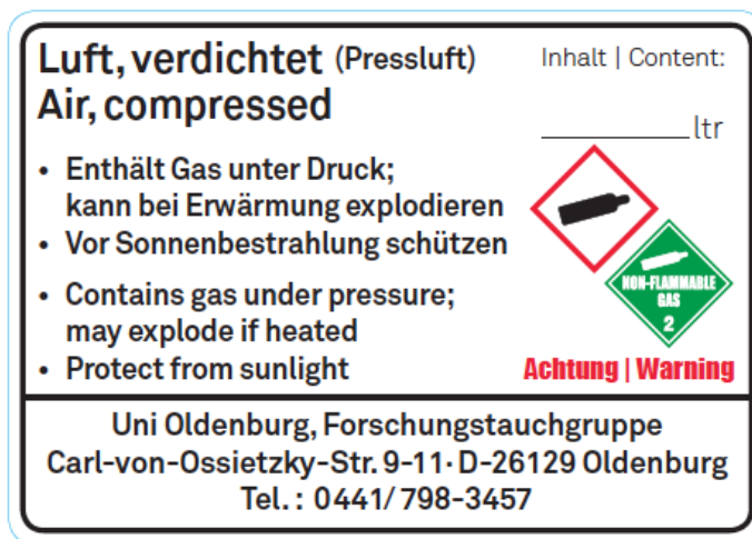
Abbildung 2) Neue zusätzliche Kennzeichnungspflicht von Tauchflaschen. Kombinierte Kennzeichnung (Quelle Fa. Domeyer GmbH & Co. KG)
